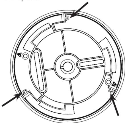
Um den Rauchmelder von der Montageplatte abzunehmen, nachdem die Arretierung aktiviert wurde, muss diese zunächst gelöst werden. Die Arretierung ist durch eine der Seitenlüftungsöffnungen neben der Summeröffnung zu sehen. Schieben Sie die Arretierung mithilfe eines Schraubendrehers von der Montageplatte weg. Drehen Sie
