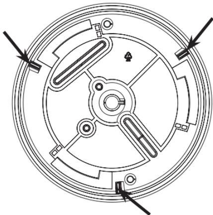
Um den Rauchmelder von der Montageplatte abzunehmen, nachdem die Arretierung aktiviert wurde, muss diese zunächst gelöst werden. Die Arretierung ist durch eine der Seitenlüftungsöffnungen neben der Summeröffnung zu sehen. Schieben Sie die Arretierung mithilfe eines
